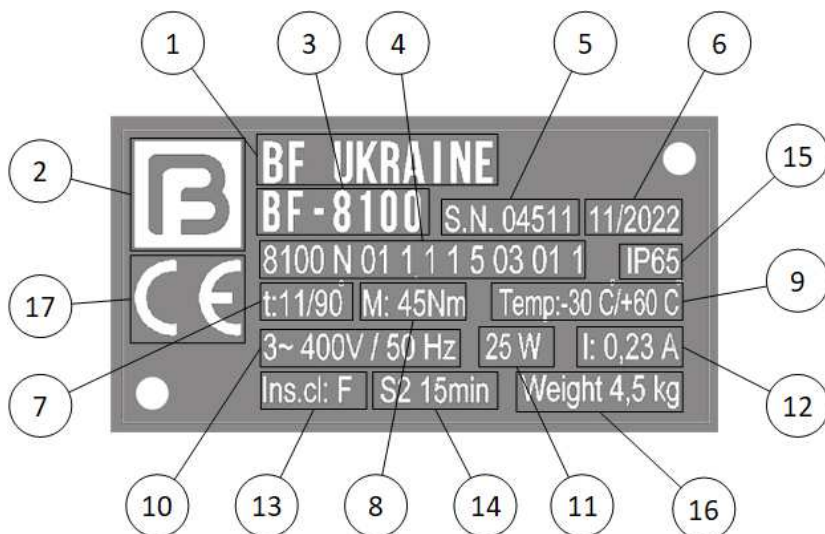
Малюнок 2 — Заводська табличка електроприводу (приклад)
